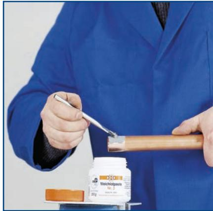
Il est important de n'appliquer qu'une fine couche de flux sur l'extrémité mâle du tube/raccord à braser, afin que pas plus qu'une partie techniquement inévitable du flux ne puisse pénétrer à l'intérieur de la conduite.
