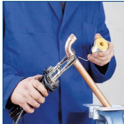
La brasure tendre doit être fondue sans l'action directe de la flamme au point de brasage chauffé à la température de brasage.
