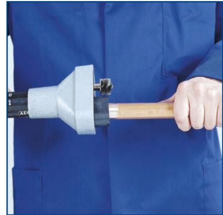
Les extrémités des tubes et les extrémités femelles des raccords à braser doivent être soigneusement nettoyées mécaniquement.
