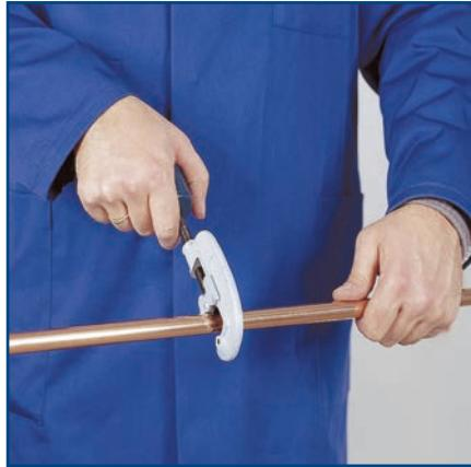
Les tubes doivent être coupés à angle droit de préférence avec un coupe-tube, ou à défaut avec une scie à métaux à dents fines ou une scie électrique spéciale pour tube.
