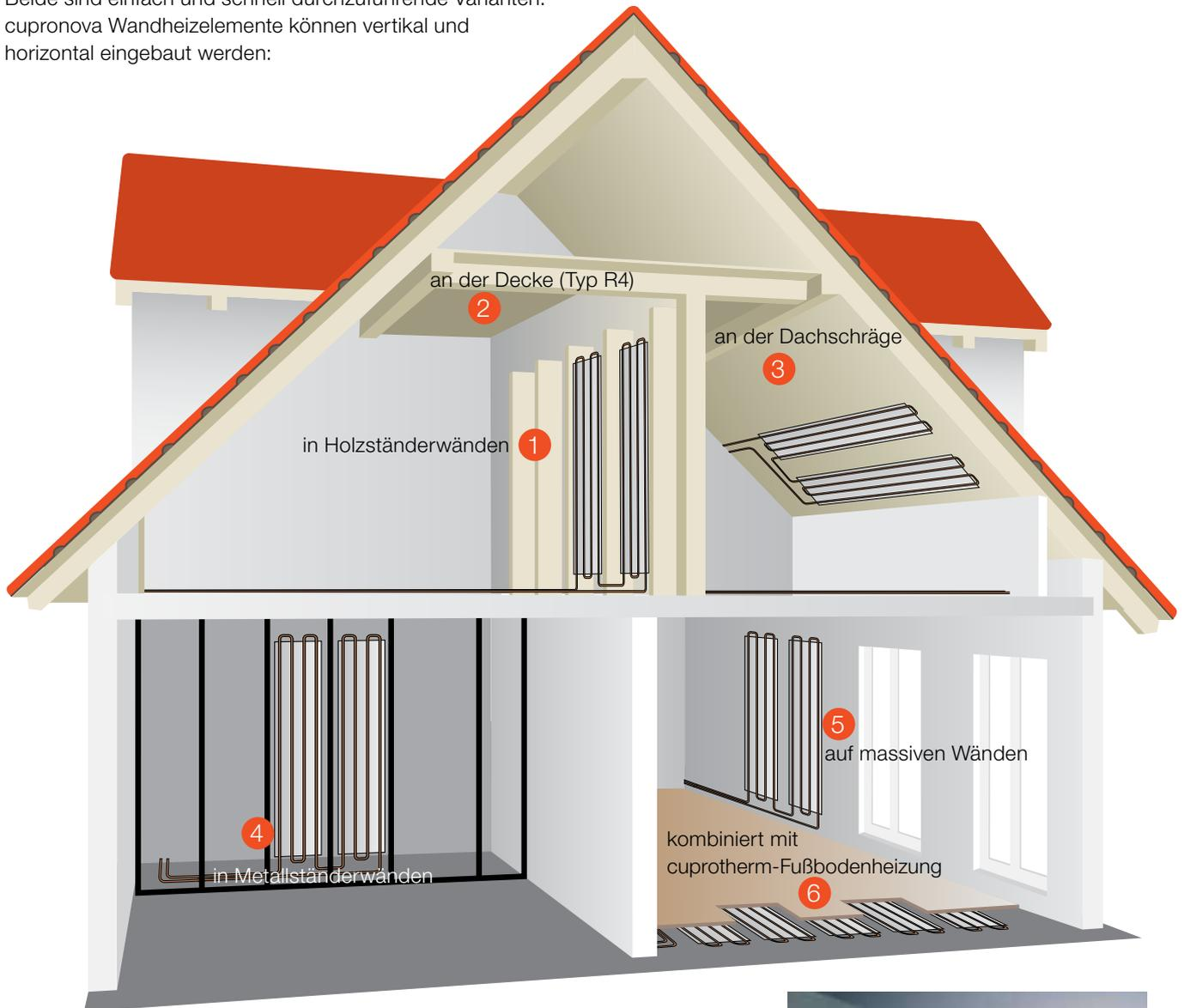
Für die Montage auf Massivwänden wird die cupronova-Montageleiste verwendet. Auf der Montageleiste wird später die Verkleidung befestigt.
